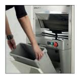
Съемный бак для сбора крошек Доступ к нему обеспечивается откидыванием передней дверцы при помощи гидроцилиндров. Емкость 18 л.
