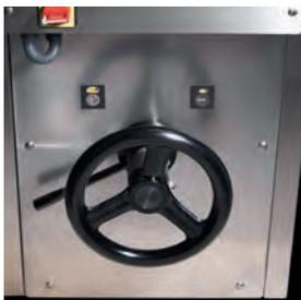
**Рукоятка для регулировки веса тестовых заготовок**
