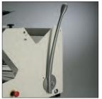
Рычаг плавной тяги Обеспечивает более качественное управление усилием.
