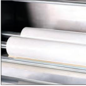
Три раскаточных валика из пищевого полиэтилентерефталата
