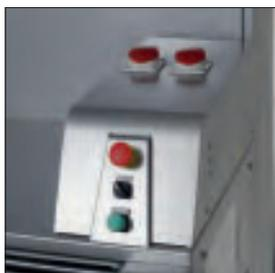
**Два трехфазных электрических разъема**
