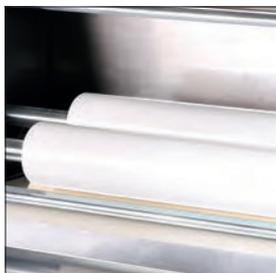
Два раскаточных валика из пищевого полиэтиленерефталата
